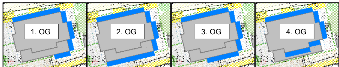
Abbildung 8. Fassadenabschnitte mit Beurteilungspegeln von über 45 dB(A) nachts Obergeschoss.
