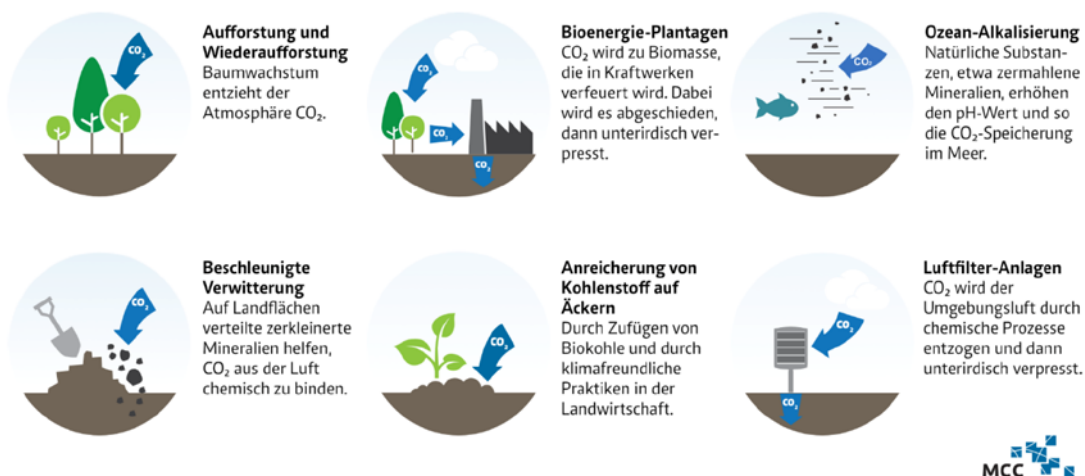
Abbildung 11: Verfahren zur Entnahme von CO 2 aus der Atmosphäre und Einlagerung von Kohlenstoff [MCC].
